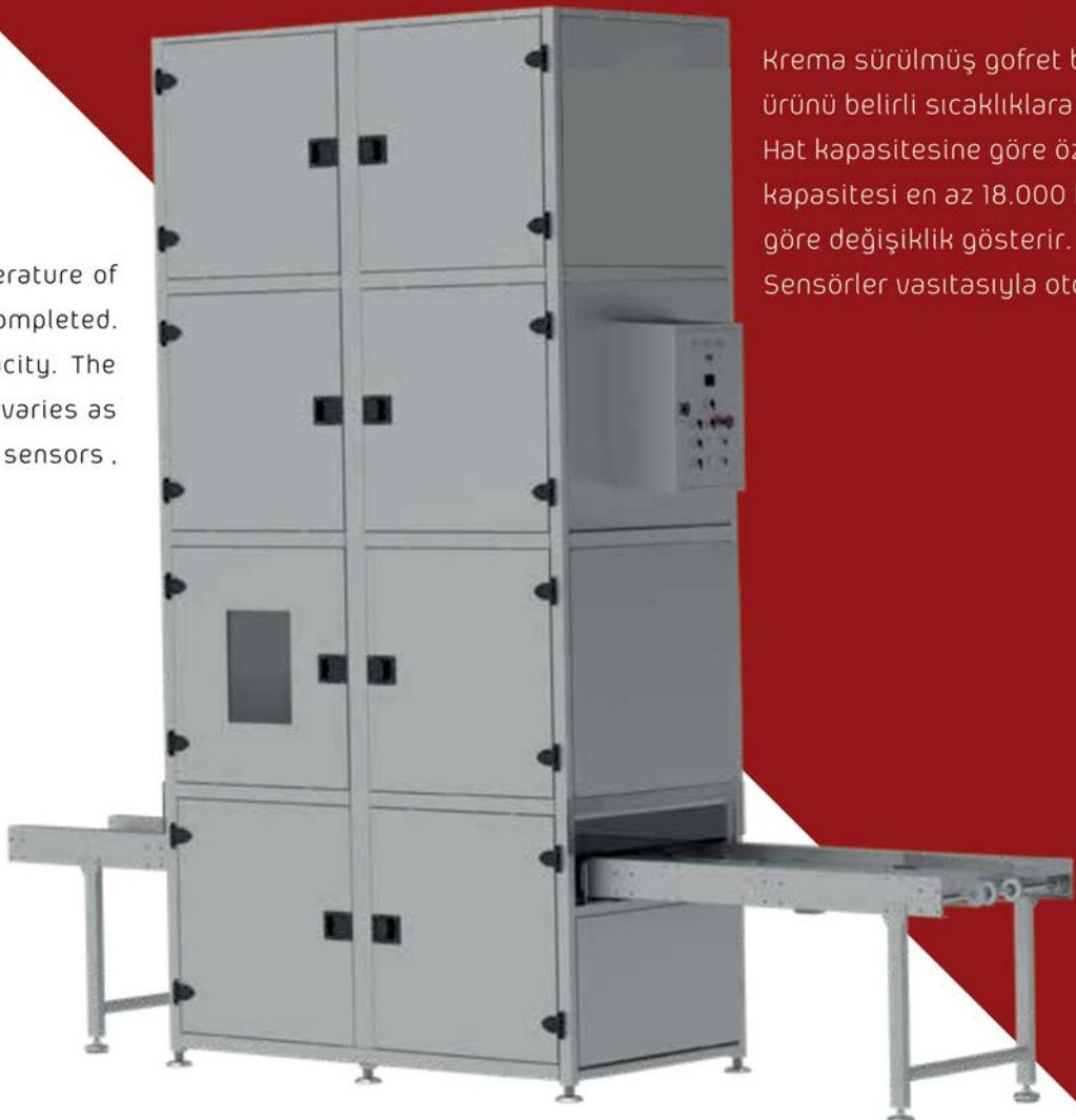
Krema sürülmüş gofret bloklarını soğutma sistemleriyle ürünü belirli sıcaklıklara düşürmek için kullanılan soğutucudur. Hat kapasitesine göre özel olarak ayarlanabilir. Soğutma kapasitesi en az 18.000 kcal/h den başlayarak kapasitesine göre değişiklik gösterir. Sistem dur kalk şeklinde çalışır. Sensörler vasisıyla otomatik boşaltma mevcuttur.
